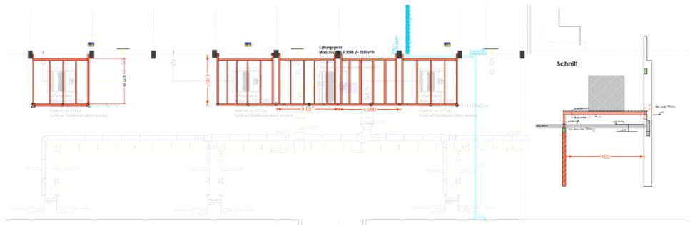
Die geplanten Lüftungsanlagen sollen auf dem Dach der Umkleidegebäude montiert werden. Dafür wird eine Unterkonstruktion aus Stahl erforderlich. Diese Unterkonstruktion soll auf die vorhandenen Konsolen der Stb.- Stützen der Fahrzeughalle und auf die tragende Wandachse der Umkleiden aufgeständert werden.
