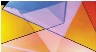
Das sogenannte „Farbeffektglas“ besteht aus nicht-farbigen Filtern die das Licht nahezu uneingeschränkt transmittieren. Sie können dennoch – abhängig vom Strahlungs- und Betrachtungswinkel – in brillanten Farben erstrahlen. Dieser sogenannte dichroitische Effekt beruht auf der Interferenz der Lichtwellen an dünnen, optisch durchsichtigen Schichten, sodass weißes Licht farbig gebrochen wird. Einfallendes Licht wird nicht absorbiert
