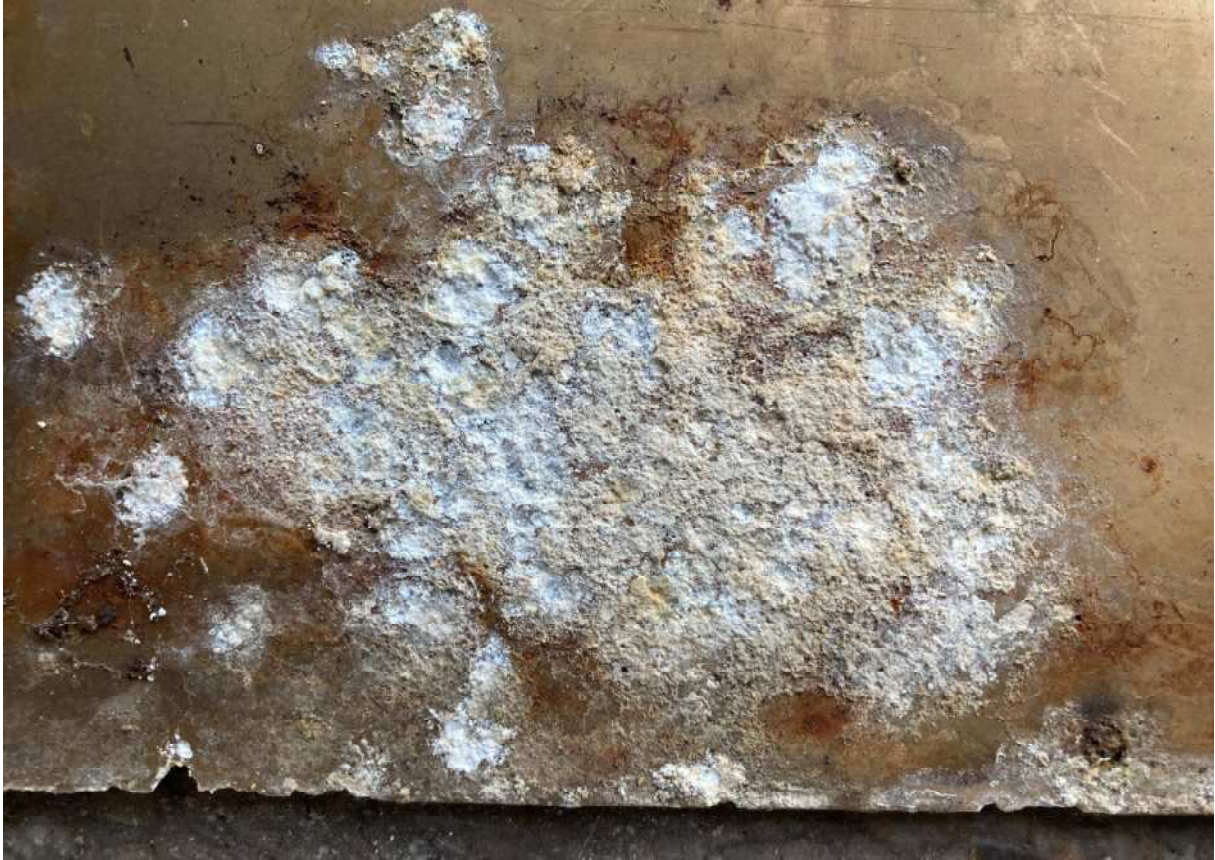
Bild 21: Zum Stahlprofil gewandte Seite der Sockelblende aus Aluminium.
